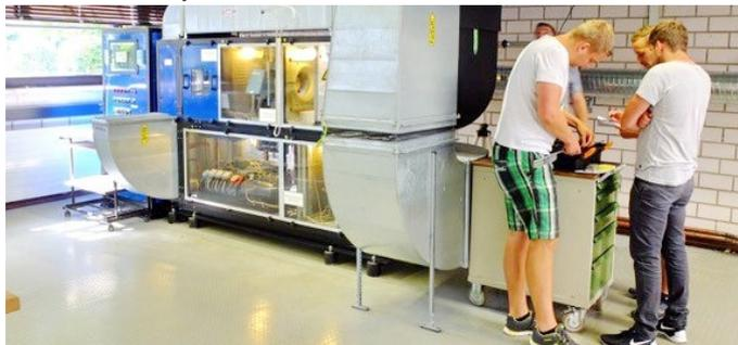
5. Leistungsmessung an einer Raumlufttechnischen Anlage
