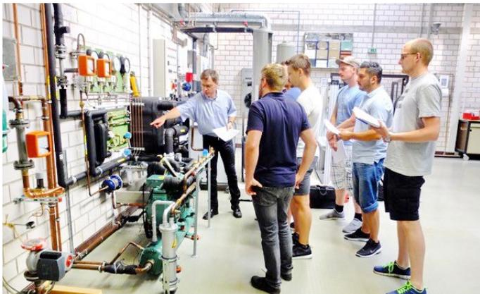
1. Leistungsmessungen an einer 2-stufigen R 407F-Kälteanlage
