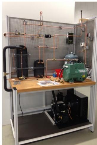
Kompakter Aufbau der CO<sub>2</sub>/R134a-Kaskade. Oben der Tieftemperatur- und unten der Hochtemperaturteil der Anlage.
