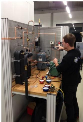
Die Teilnehmer führten an der fertig gestellten Anlage eine Dichtheitsprüfung durch.
