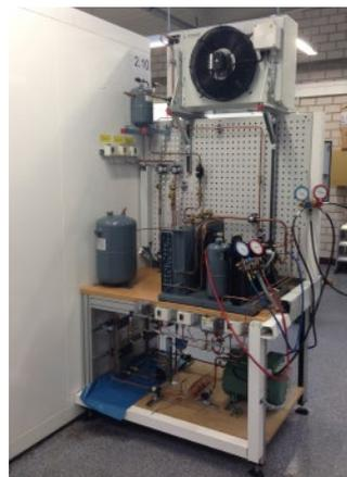
Im unteren Teil ist die CO<sub>2</sub>-Tieftemperaturstufe untergebracht, darüber der Kälteteil für die Hochtemperaturstufe - alles klein und kompakt.
